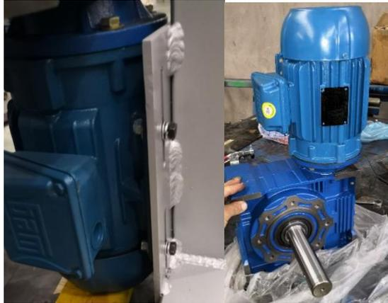
Ilustración 36: Motor instalado y ensamble del motorreductor
