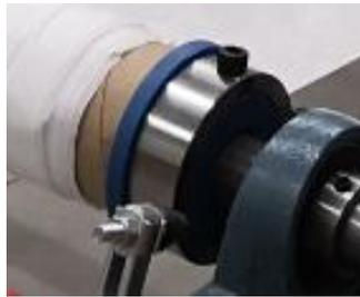
*Ilustración 19: Cabezal de acero*
