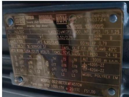
*Ilustración 22: Datos del motor para la conexión*
