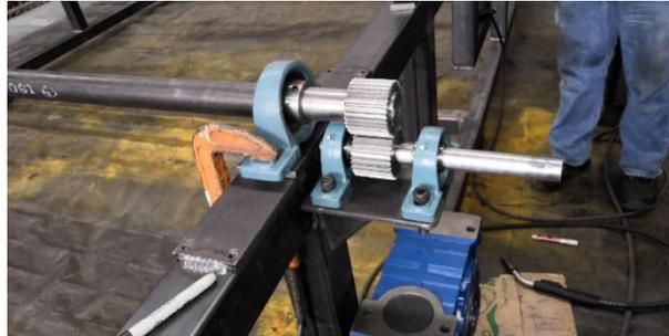
*Ilustración 38: instalación de chumaceras y de la flecha con los engranes*
