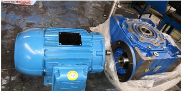
*Ilustración 21: Motorreductor ensamble*
