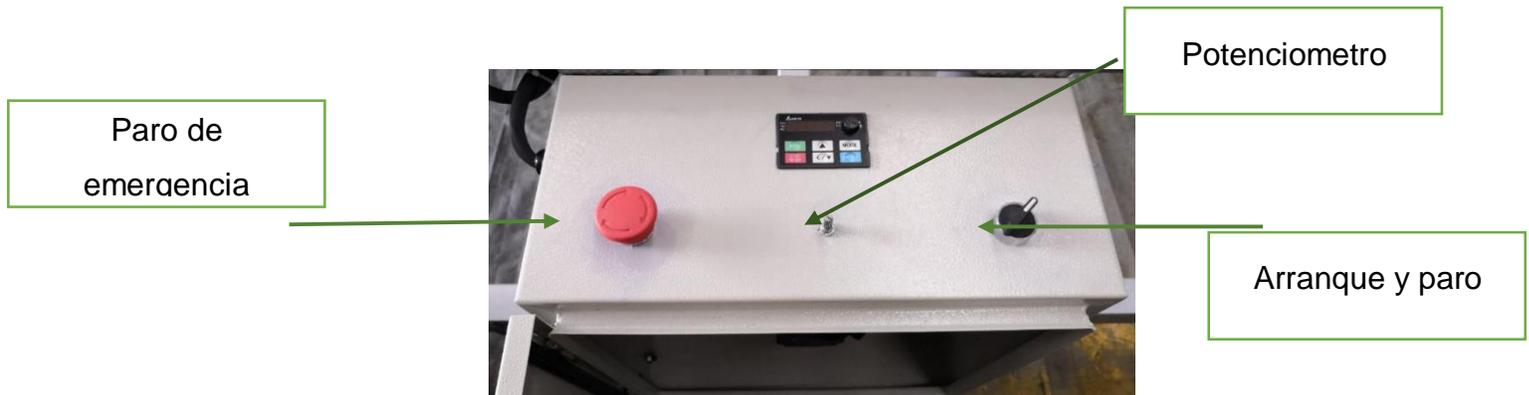
*Ilustración 26: Dispositivos electrónicos conectados al variador*
