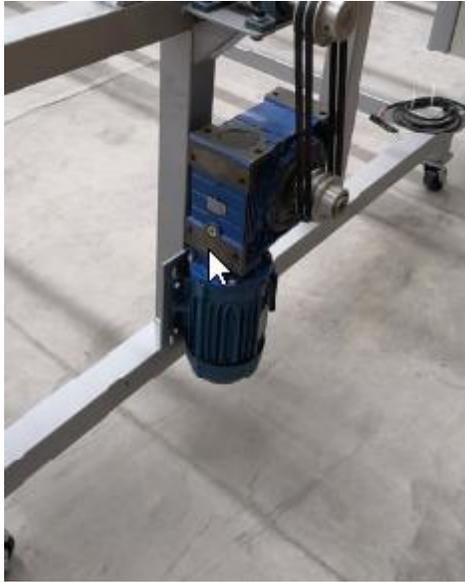
*Ilustración 45: Instalación del motorreductor*
